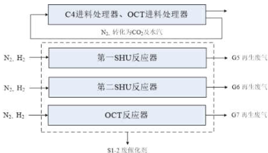
图 3.5.4-7 再生处理工艺流程图
